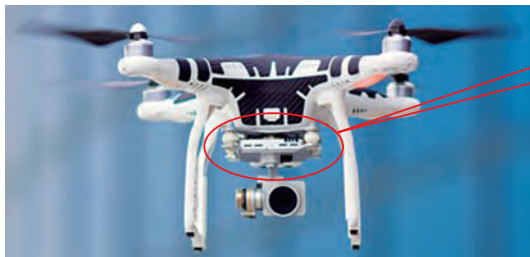
ドローン (カメラへの振動抑制) Drone (Suppression of vibration to the camera)
